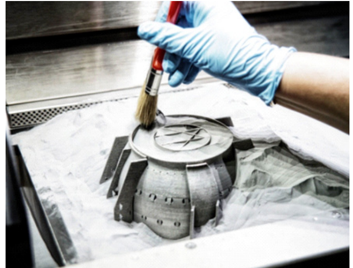
Şekil 15: TEİ’de kurulu metal katmanlı imalat tezgâhı ve üretimi üzerine çalışılan yanma odası
